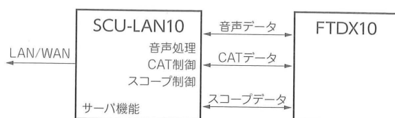
図2 SCU-LAN10とFTDX10の関係
