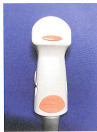
マイクロコンベックス型プローブ 中心周波数7MHz前後
