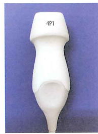
セクタ型プローブ 中心周波数5MHz前後
