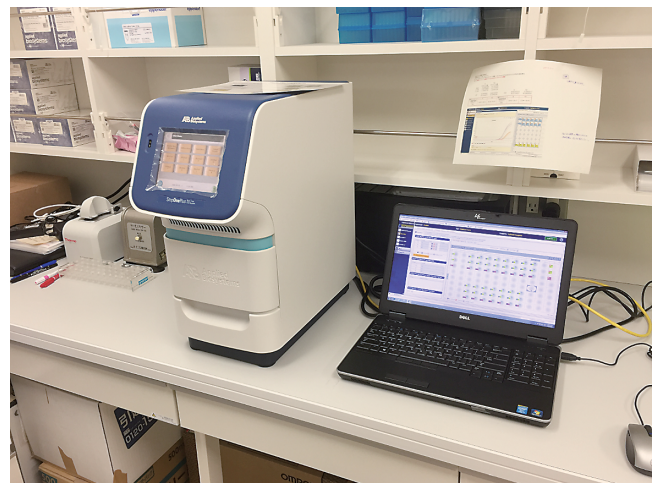
図4 リアルタイムPCRマシン本体とそれを制御するノートブック型パソコン
