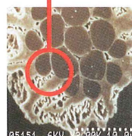
外側はポリスチレンで、内側は 化学的に安定なポリプロピレン。 繊維表面は多孔質で表面積を 大きくしています。
